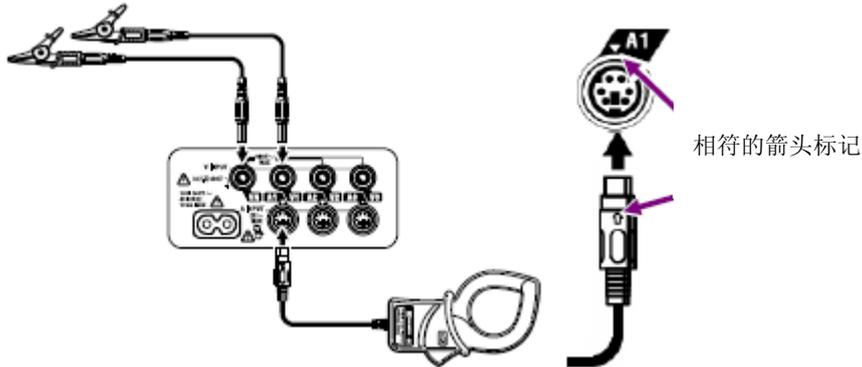
电压测试线与钳形传感器的使用数量及连接场所因连接方式的不同而不相同。详情请参考说明书 **5.2 基本连接方式**。
