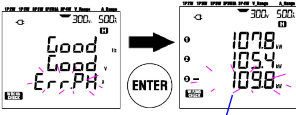
此例表示 A3 的传感器的安装方向可能装反了。
