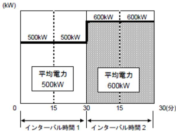
上述间隔时间 2 中，前 15 分钟内消耗 600kW，若后 15 分钟控制为 400kW 后，间隔时间 2 的平均电力与间隔时间 1 相同，可控制为 500kW。
